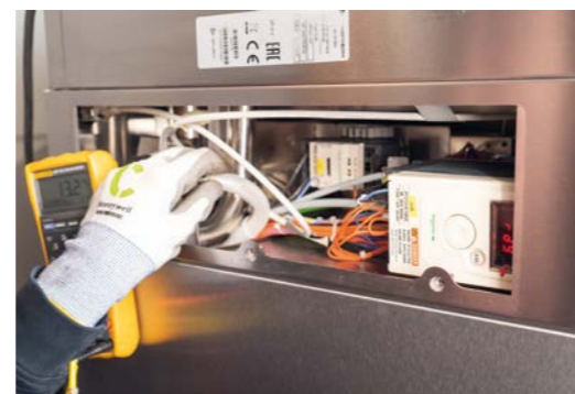
Die rundum servicefreundliche Konstruktion des Convotherm mini mit seinen vier Service-Ports macht die Wartung und Reparatur einfacher, schneller und kostengünstiger.
